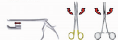
Abbildung 2: Modell der Relativbewegung übertragen auf Stanzen, Scheren und Klemmen
